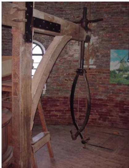
De “los” staande steenkraan. De beugels werken als een schaar als de steenkraan gedraaid wordt en de beugels bewegen
