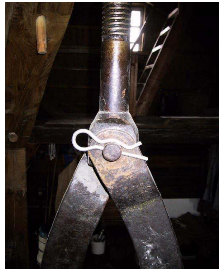
In een aantal gevallen is het noodzakelijk dat de kraanbeugels met de schroefdraadspindel wordt geborgd. Dit kan bijvoorbeeld met een borg splitpen
