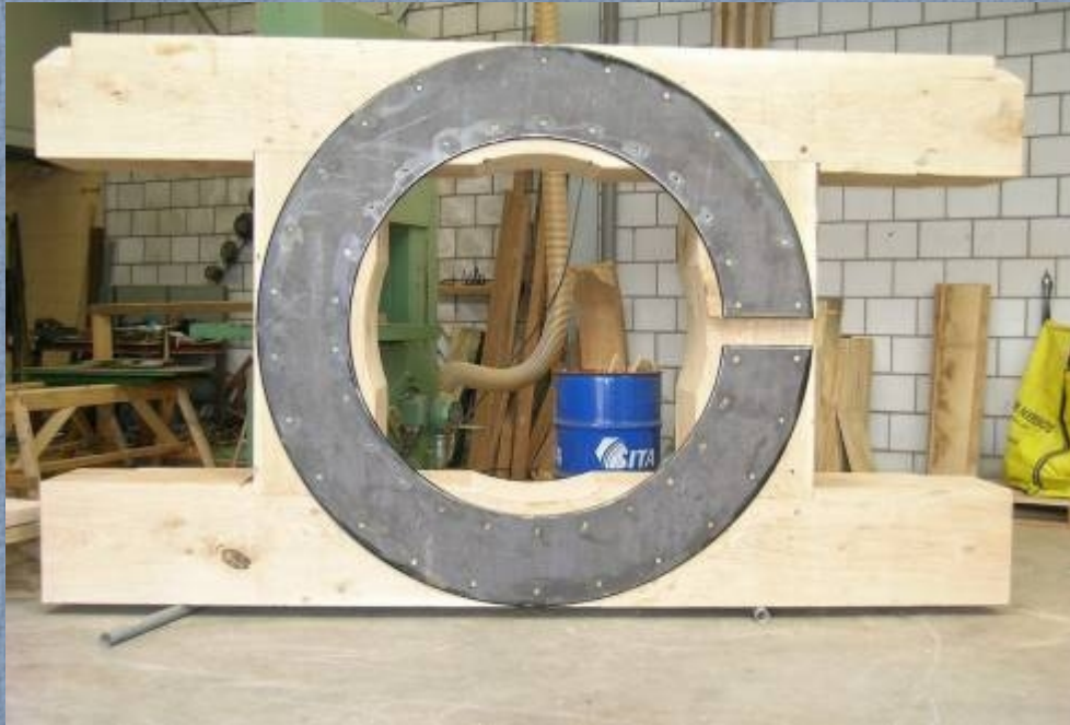
Stalen ring op steenburriebalken/kalven
