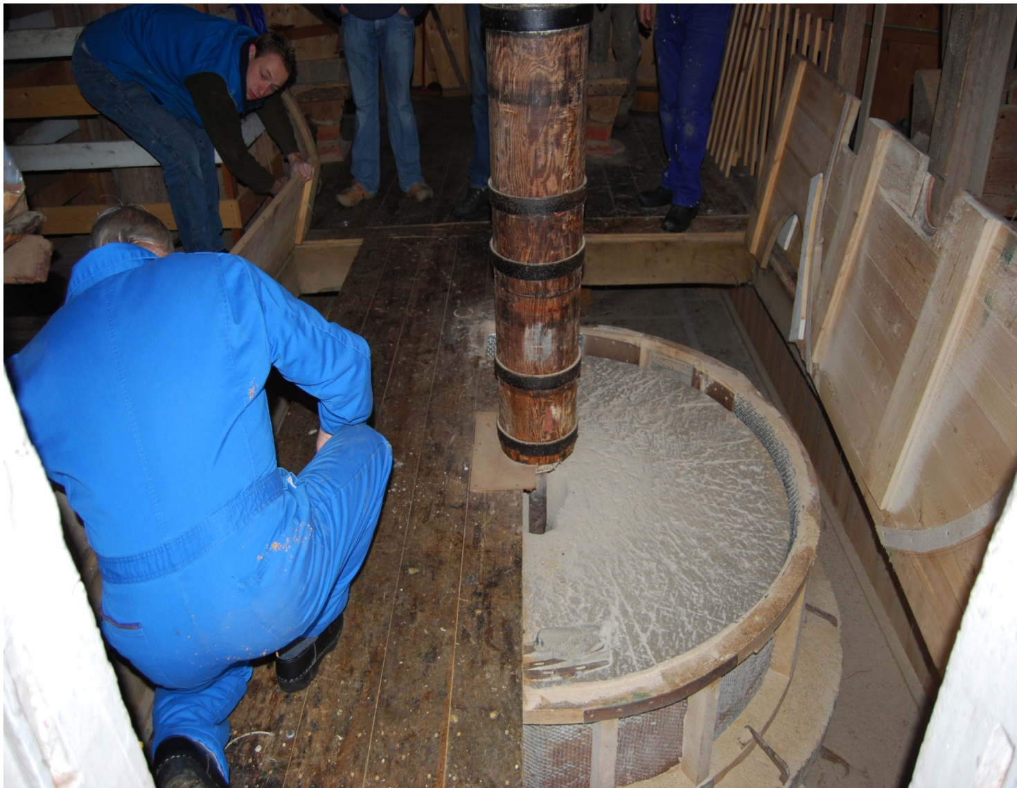
Spijk: pelsteen (zandsteen) onder stellingzolder. De stenen (soms 1) liggen in de dustgroep.
