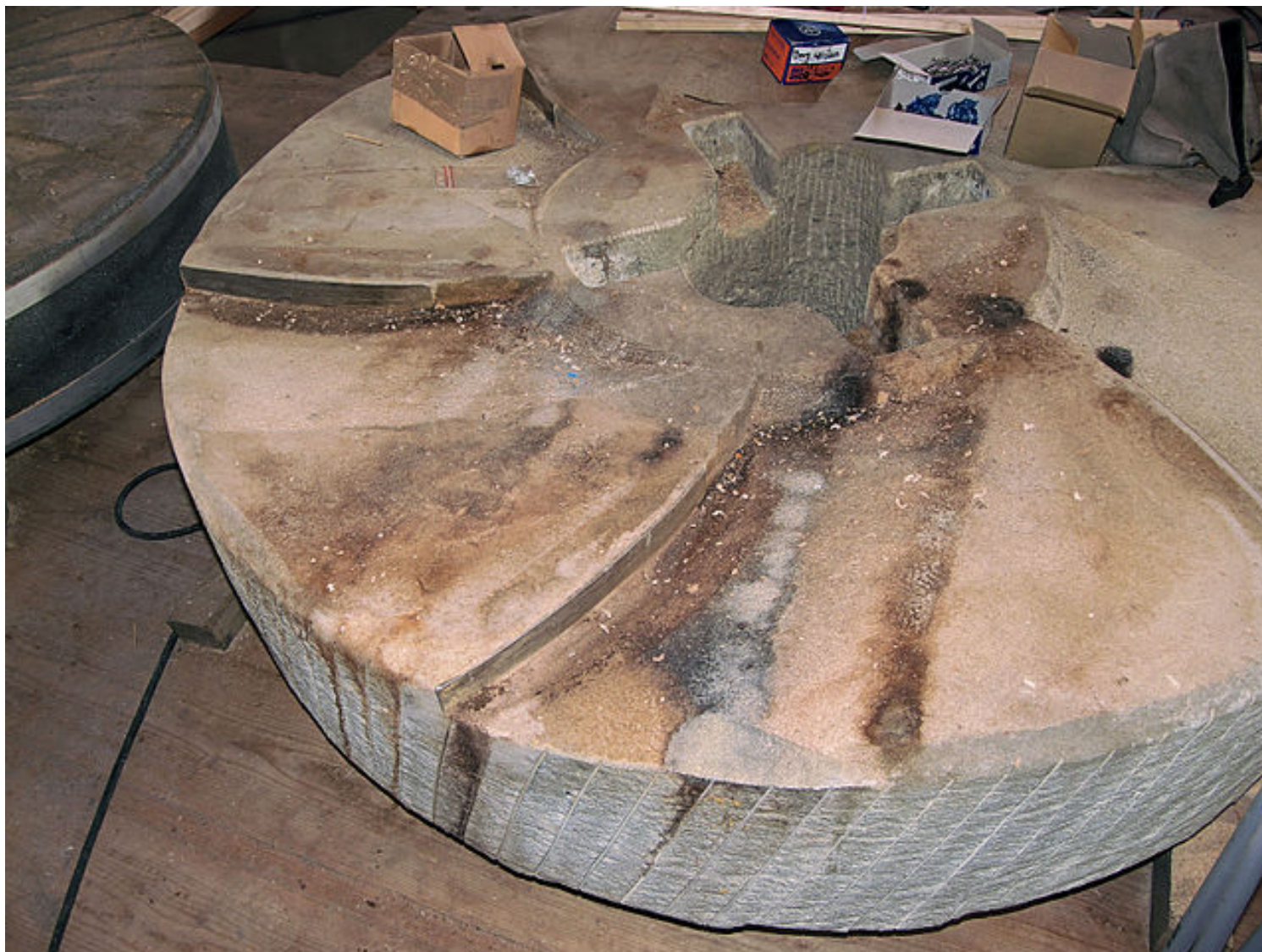
Ermelo De Koe: onderzijde pelsteen met zoggaten en -ijzers
