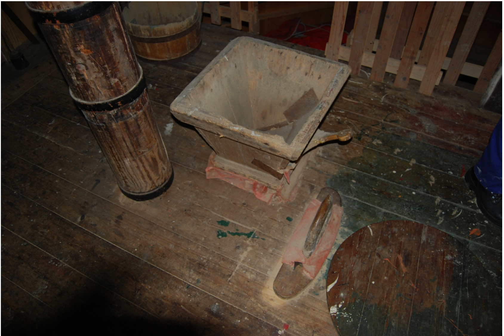
Spijk: pelspil, gerstkaar met inlaatschuif , aflaatschuif en deksel (waaronder schootemmer)
