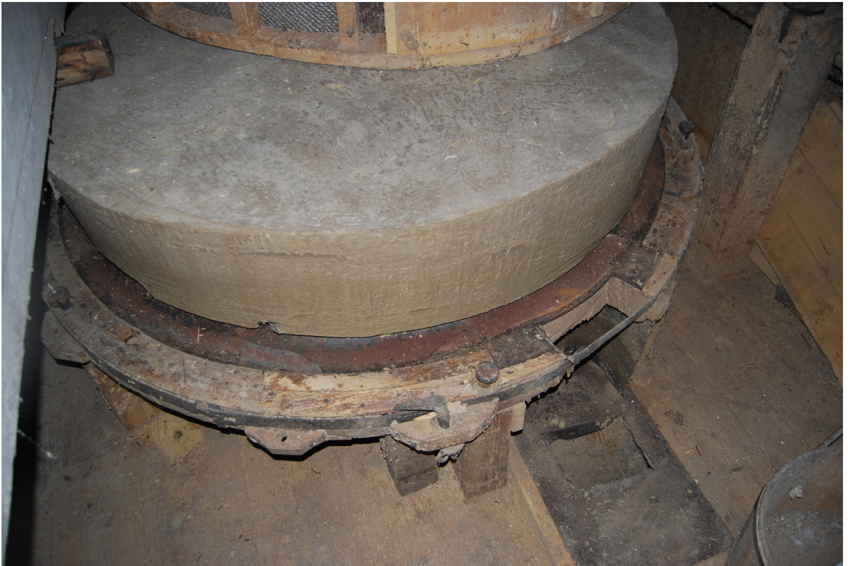
Oldehove De Leeuw: loper (pelsteen) met ijzeren ligger
