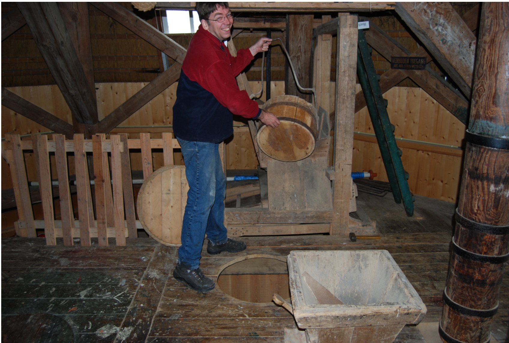
Spijk: Henk Doornbos doet de gort op de zifterij; sorteren op korrel-grootte Hij staat bij de 'noaloper'. De haalfschillen (of overschillen, bij de 2e run) gaan in 1 zwaai in de zeefkaar.
