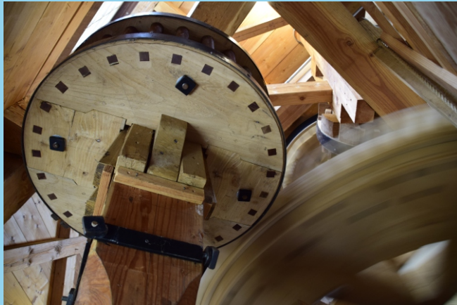
Onderaanzicht van de steenschijfloop en steenspil
