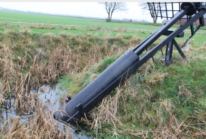
Een vijzelton pompt het water omhoog
