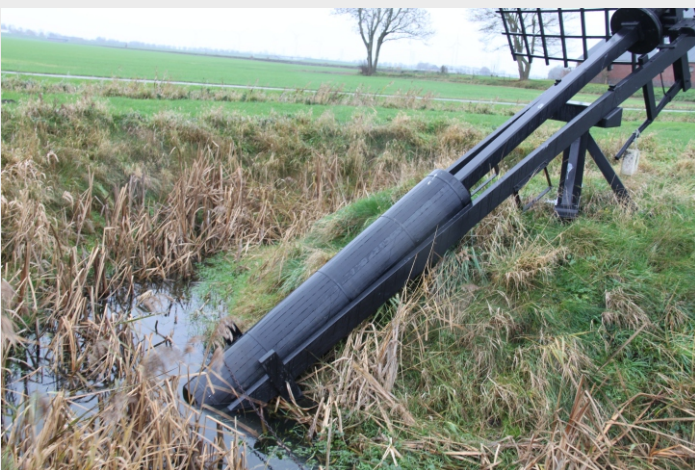
Een vijzelton pompt het water omhoog
