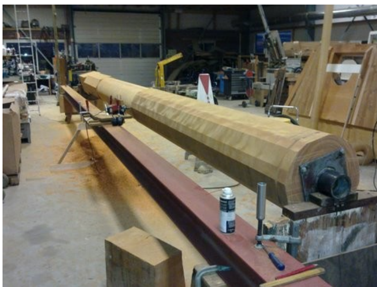
Afbeelding 12: De vijzelbalk wordt over de lengte van de drie gangen, die zo meteen de kenmerkende 'schroef' vormen, rondgedraaid.
